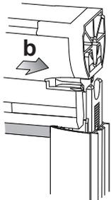
... (c) En redéposant le boîtier, faire pénétrer les fourches dans l'embout.
